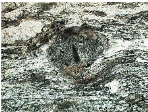
Figura 2 – Porfiroclasto rotacionado formando estrutura tipo \delta e denotando movimentação “dextral”. Escala horizontal da foto 5mm.
