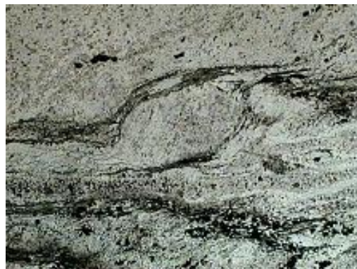
Figura 3 -Porfiroclastos feldspático com franjas assimétricas formando estruturas tipo \sigma ( sigma ) denotando movimentação “dextral” para o sistema. Escala horizontal da foto 5mm.
